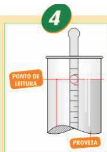
Colocar um litro de etanol etílico hidratado em uma proveta de mil ml, de modo que o densímetro flutue livremente sem tocar o fundo ou as paredes da proveta.
