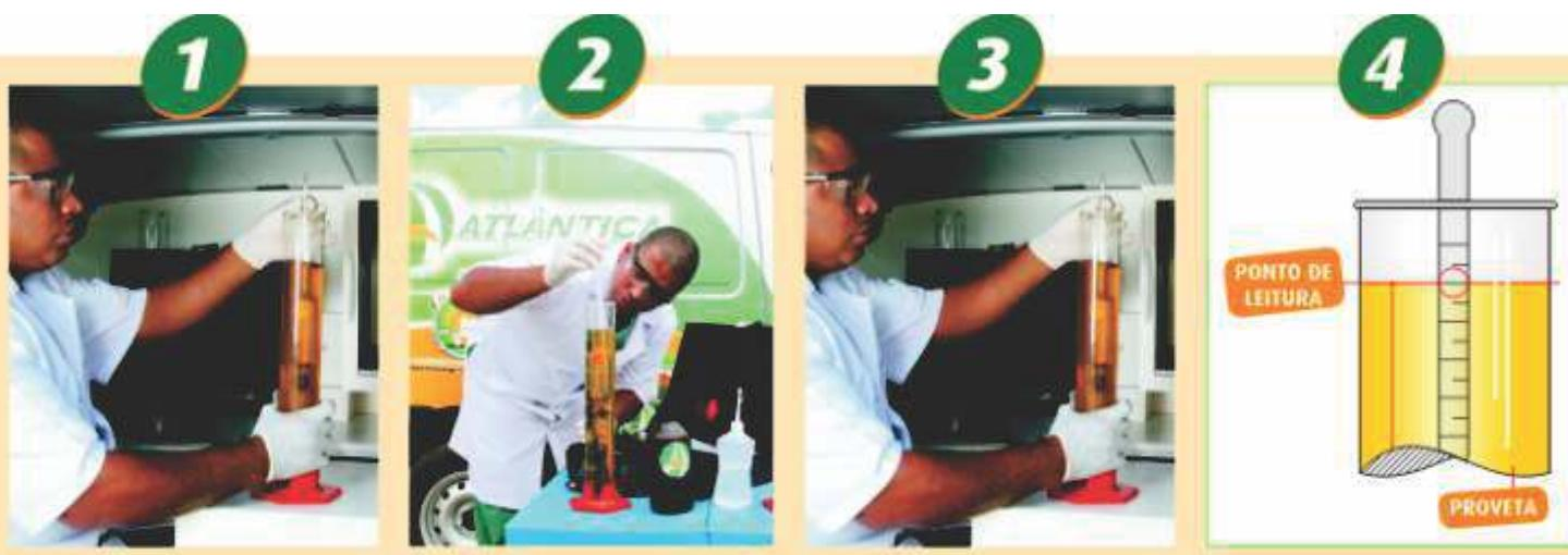
Colocar 1 litro de gasolina em uma proveta de 1000ml, de modo que o densímetro flutue livremente sem tocar o fundo ou as paredes da proveta.
