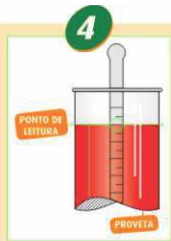
Colocar 1 litro de óleo diesel em uma proveta de 1000 ml, de modo que o densímetro flutue livremente sem tocar o fundo ou as paredes da proveta.
